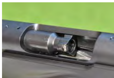
L'otturatore ha tre tenoni in testa con angolo di apertura di 60°.
